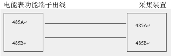
图 6 电表的 RS485 接口和采集装置的 RS485 接口
