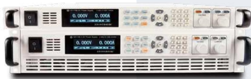
DH1798 系列宽量程可编程系统直流电源提供 14 款型号，输出电压 / 电流最高可达 600V/180A，单机功率最高 3KW，并且采用标准 1U/2U 机箱，便于上架使用。该型产品具有高分辨率和精度，低纹波和低噪声，高稳定性，高可靠性等特点。标配 LAN，USB，GPIB、RS485（或 RS232）接口；具有过流、过压、过热保护功能，可实现电压预置、电流预置、过压保护预置、输出 / 禁止、菜单设置 / 回读等功能。
