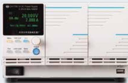
DH1790 系列是一款宽量程可编程直流电源，体积小、重量轻，电压电流覆盖范围宽，该系列提供 12 款型号，功率覆盖 180W、360W、720W、1080W；具有高分辨率、高精度、低纹波、低噪声、可编程、稳定性高等特点。具有恒压恒流两种模式输出，同时具备过压、过温、过功率等保护功能。该产品可以灵活串并联组合；可快速保存当前设置参数，便于下次使用时快速调用，支持 LIST 序列编程，标配 RS232、LAN、模拟接口。
