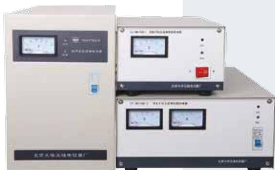
该系列电源采用正弦能量分配技术，相位叠加、LC 净化电源结合，在国内外同类产品的基础上取其优点，使该系列净化稳压电源的性能、指标上更为先进。由于国内电网污染严重，尖峰干扰很大，对使用计算机系统、自动控制设备的用户造成很大威胁。该系列电源能把这种威胁减少到最小。其尖峰抑制能力大于 35dB，该电源反应速度快、效率高、波形失真小、可靠性高、负载适应性好。设有过压保护等功能，特别适用于使用 220V50Hz 交流电的工程、医院、研究所以及国民经济各部门。
