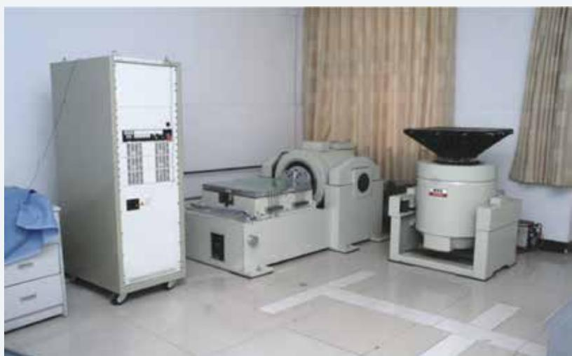
计量检测中心前身为信息产业部电子华北区域计量站和北京大华无线电仪器厂计量中心，隶属于北京大华无线电仪器有限责任公司。计量检测中心通过了 CNAS 和 DILAC 实验室认可，现设一个校准室和一个环境试验室。其中校准室包括时间频率、电学和无线电三个参数室，可以承担对时频、信号源、示波器、数字多用表等设备校准。环境试验室可以进行高低温、湿热、振动、冲击、电气安全等各种环境试验，可以满足军用装备实验室环境试验、军用通讯设备环境试验、电工电子产品环境试验、电子测量仪器可靠性试验、电子产品环境应力筛选方法、医疗电气设备环境试验等相关标准对环境试验设备的要求。
