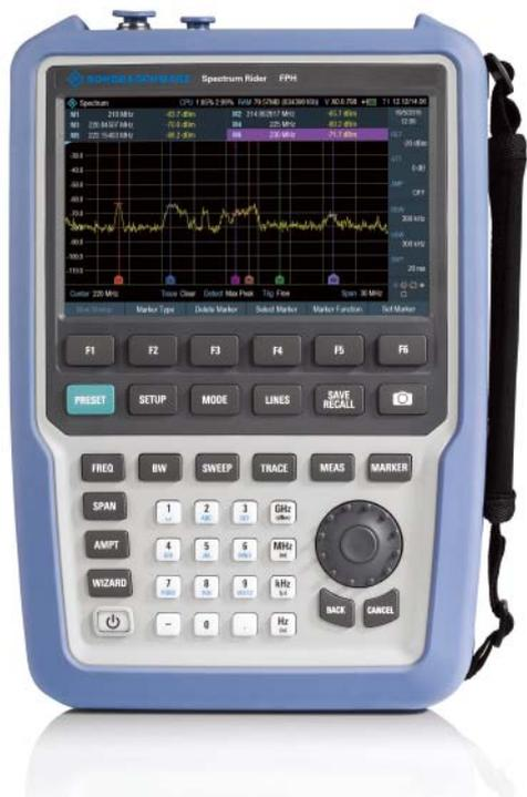
R&S®Spectrum Rider是一款功能多样、易于操作的仪器，在设计上兼具坚固与美观两个方面。标配分析仪的频率范围是5 kHz到2 GHz。其频率上限可通过密钥轻松扩展到3 GHz或4 GHz。
