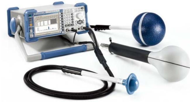
R&S®TS-EMF天线用于精确的电磁场场强测量，尤其适合场强覆盖测试以及电磁环境评估。无论是通信监管机构、环境保护局还是移动运营商、广播电视、电力运营公司以及无线设备的安装调试，R&S®TS-EMF均是不可或缺的。
