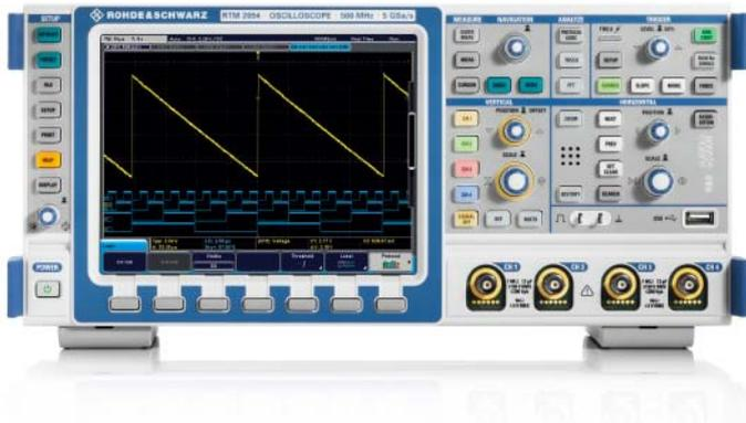
使用简便并快速获得可靠结果是用户对R&S®RTM台式示波器的期望。R&S®RTM启动速度很快，当其它示波器还在启动时，它已显示出信号并给出分析结果，并且这些信号在使用其它仪器时可能会被噪声掩盖。通过虚拟屏幕功能，它可在一个屏幕上显示所有通道信号，并能快速执行各种分析功能。
