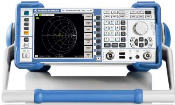
R&S®ZVL是罗德与施瓦茨公司推出的经济型台式矢量网络分析仪。不同于市面上其它的产品，R&S®ZVL具备了强大的扩展能力，除了传统的矢量网络分析，R&S®ZVL还可以进行全功能的频谱分析，噪声系数分析和信号解调分析，R&S®ZVL配有准峰值检波器和EMI带宽，因而可以帮助客户进行EMI的诊断和预兼容测试。无论是产品的开发定型还是批量生产阶段，R&S®ZVL都是预算有限客户的首选。
