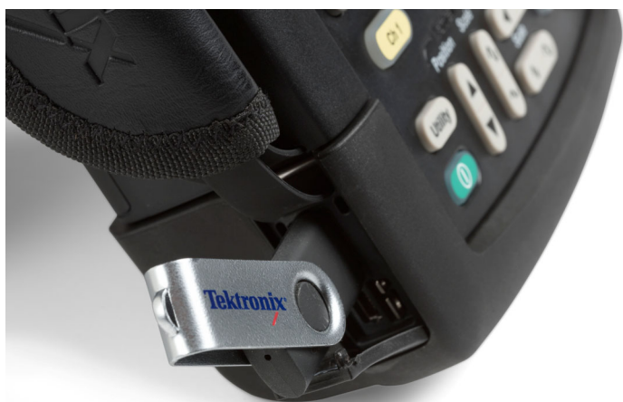
标配 USB 端口，方便数据存储、数据传送和仪器控制。
