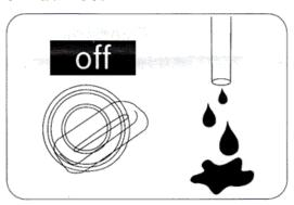
6. 充分注入空调清洗剂后(约需2分钟),再等待风扇转动10—15分钟后,将空调风量的开关调到off位置,关掉引擎。约10分钟后有废液从排出口流出。
