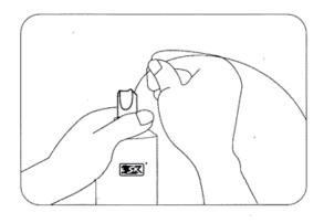
3.请将附属的导管紧紧接入喷嘴。● 请注意当按下阀门时,确保接口处无 气体漏出。
