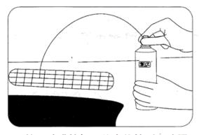
5. 按下喷嘴按扭,往右旋转到无法再转动的位置后强力泡沫将自动喷出。 ● 光 更取出物管时 请将喷嘴按钮往
