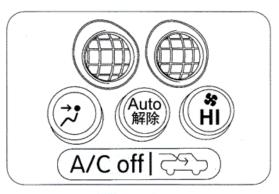
2. 将空调设备的自动开关及冷气开关 调到off位置,打开空调外循环模式, 使外部空气导入,并将空调风量的开 关调至最大。
