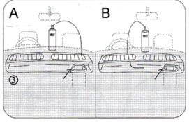
4.试找出空调进气口吸力最大的位置(可用手或废报纸测试并找到进风口最大吸力处,根据车种的不同位置也有所不同)。A.在司机位处,充分摇匀后,请导管口往副驾驶位处,充分摇匀后,访看。B.在副驾驶位处,充分摇匀后,请将导管口插入较浅的位置。无论哪种情况下,都请在空调进气口吸力最大的位置插入导管。
