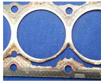
未使用防冻液的汽缸顶部垫圈
