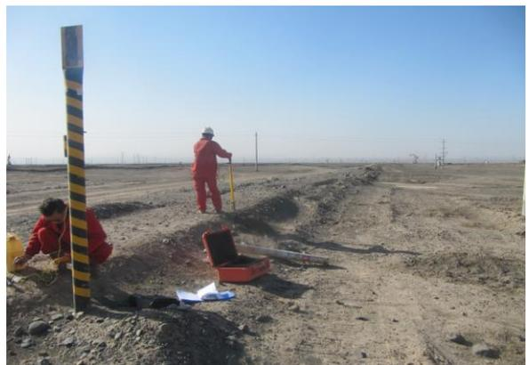
DCVG/CIPS-埋地管道防腐层检测
