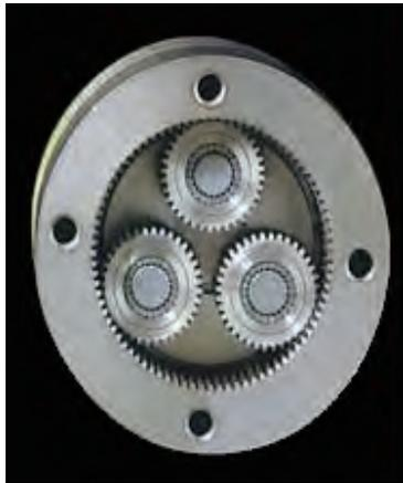
AE系列减速机齿轮采用38CrMoAl钢离子氮碳共渗，以及最大化的内部结构空间。较一般同尺寸外型圆型减速机有更长的寿命，更大的承载力大。
