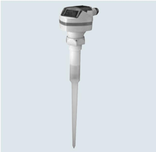
SITRANS Probe LR 是一种两线制回路供电 5.8 GHz 雷达变送器，用于储罐液体、浆料或过程容器中液体的监测，量程 20 米。
