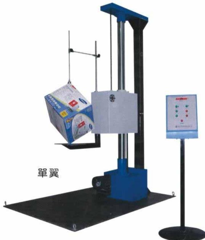
单翼式跌落测试机 V-15D 示意图
