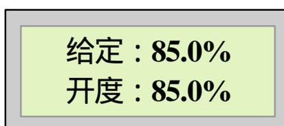
进入自动运行方式，执行机构根据控制指令信号给定的开度（电流）值，控制执行器的电动机转动，使联动的调节阀开度跟随控制指令信号的变化而变化。保持阀门的开度和指令一致。
