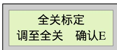
按动“ ”“ ”将执行器调至全关位置（此时的开、关键动作方向不确定，应观察动作方向，确定操作那一按键）。按下键，执行机构电机运转。松开按键停止，调至全关后按下“ E ”键，等显示器出现“全关 OK”时，全关标定完毕。进入下一步全开标定。
