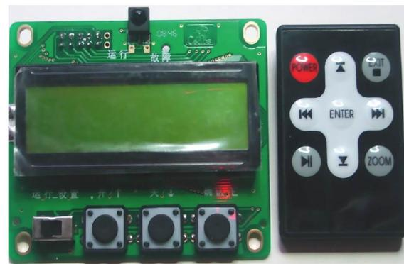
CSDn-H 型电动执行控制器安装于执行机构内，构成机电一体化的电动执行器。操作方法简单，红外遥控设置，就地遥控操作，减轻了工作强度。使得现场安装与调试，操作更加方便易用。
