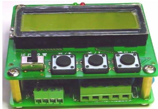
CSDn-H型的设计，以高稳定性，高可靠性为设计目标，综合了当前世界主流电动执行控制器的优点，集中了它们的全部保护与自诊断功能，并增加了独特的故障诊断与保护电路。控制器在性能方面，控制板主件采用进口高性能工业级器件，性能稳定，抗干扰能力强，在软件上根据电动执行器本身工作特点开发的专用数字滤波软件提高了整体的抗干扰性。控制采用自适应算法的定位软件，使得定位误差（基本误差）更小，控制精度更高，使得 CSDn-H型控制器具有更优异的性能。
