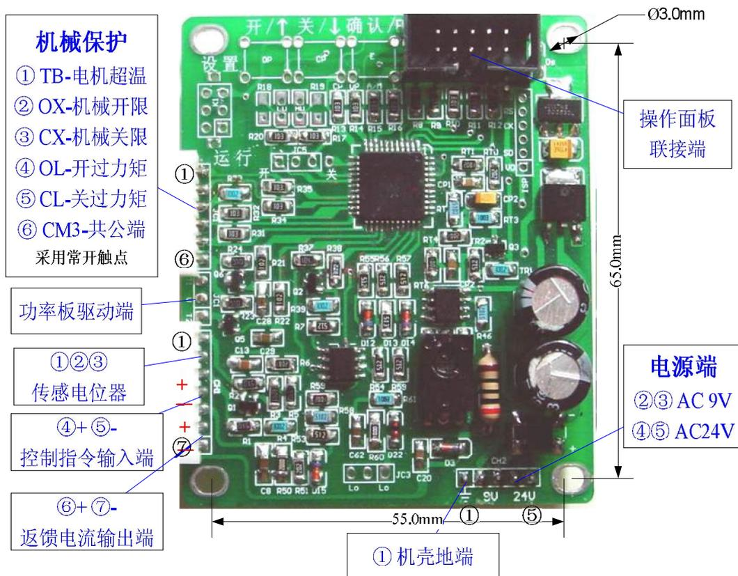
注：传感电位器滑动端必须接在控制板接线中间端子上
