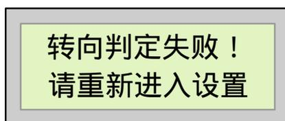
检查位返电位器（传感器）的安装是否正确，传感器的联动是否良好。重新上电，进入设置进行“行程标定”。
