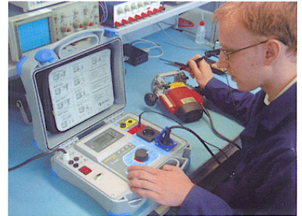
维修车间便携式装置的检测
