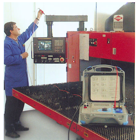
机器安全方面全面测试 (初始安装或定期)
