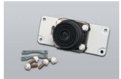
众多的附件中，包含电缆进线之用的软质橡胶头，适用于SFS规格F2尺寸法兰板(F2CE.1)电缆线径范围 27-66mm。
