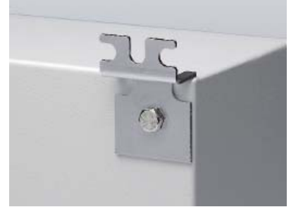
壁挂式脚座支称高度, 20mm (EFFL2. 20) 和 50mm (EFFL2. 50)。采用2mm厚不锈钢板制造, 可以水平或垂直装于箱体底部。
