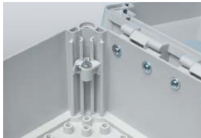
底板、中隔板安装于特殊滑轨器(OEL1)，即可任意调整高度，滑轨器包含有M5固定螺丝。
