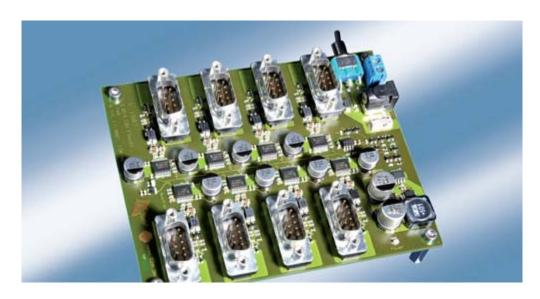
FlexAS 是一种用于 FlexRay 总线系统主动星型耦合器。特别适合于安全性相关应用, FlexAS 扩展了总线系统的可靠性和可用性。FlexAS 为实验室应用而设计. 为了使所有的信道能用, FlexAS 没有外壳。
