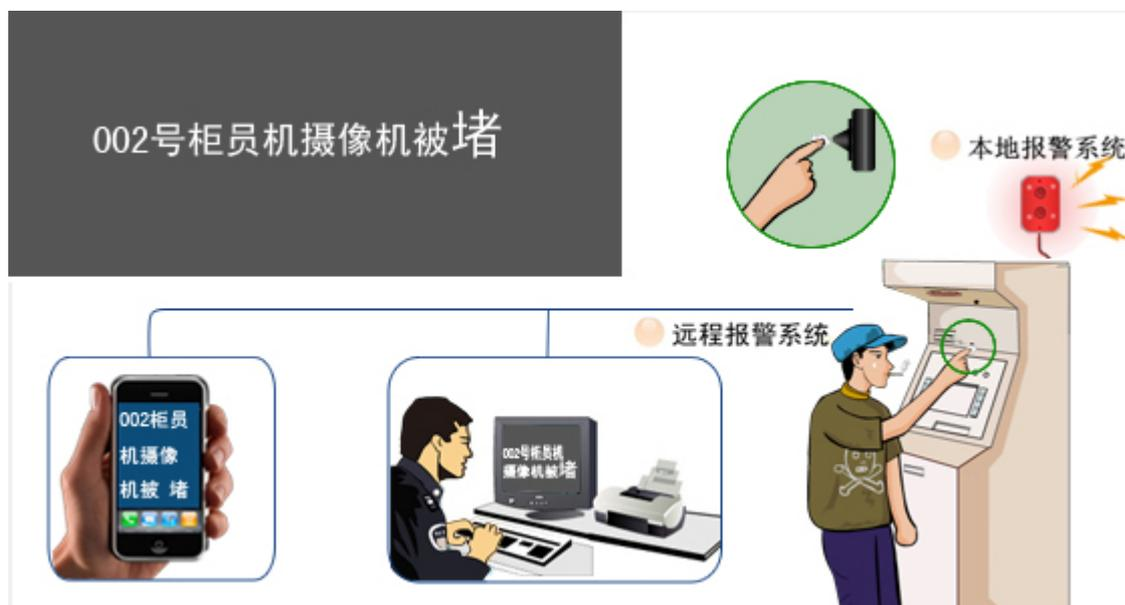
4.3.9 视频丢失报警：当视频被破坏（视频线被剪断、视频电源被切断、摄像机损坏等等）的情况下及时报警提醒，避免录下无用视频。
