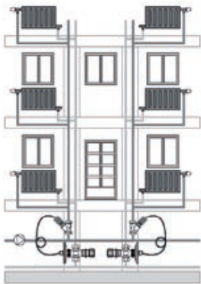
图1：Kombi-PC 应用于散热器下供下回双管供暖系统维持立管供回水的压差恒定
