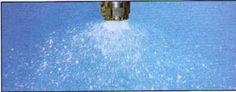
Q-Sun利用纯净水喷淋来模拟户外潮湿侵蚀。
