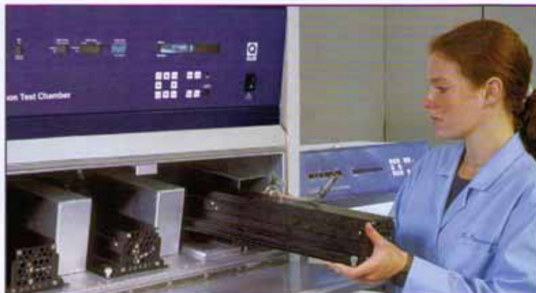
从试验箱的前部可以轻松取出Q-Sun气冷氙灯。
