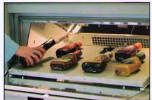
三维样品可直接放在样品架上，大多数情况下不需要样品夹。
