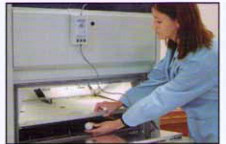
CR20的UV传感器放置在样品架的校准端口内。
