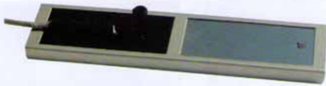
黑板温度传感器安装在2×4"样品夹上。
