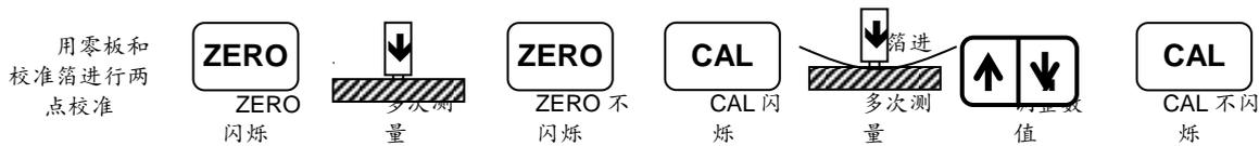
按 **ZERO** 键，开始零校准，显示屏将显示 ZERO(闪)和 MEAN(不闪)，”MEAN”表示读数是平均值。
