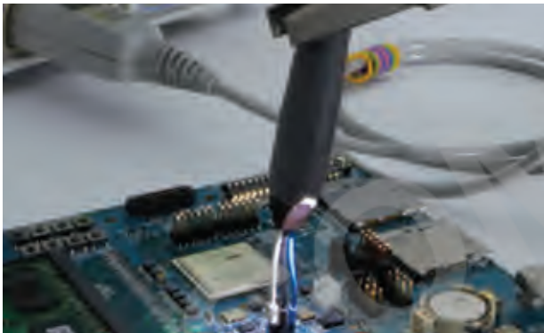
InfiniiMode 探头一次连接, 无论是使用焊接式, 还是插孔式连接, 就可以得到单端、差分 and 共模波形
