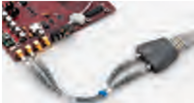
N5444A InfiniiMax III 2.92 mm SMA 通过 N5448A SMA 柔性电缆连接到 电路板的 SMA 连接器
