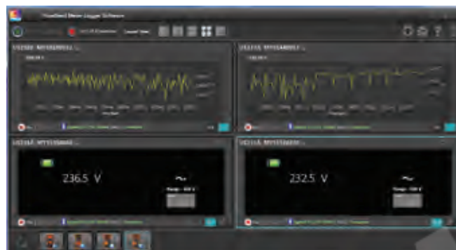
使用 Keysight Handheld Meter Logger 软件查看多达 10 个手持式仪表的读数
