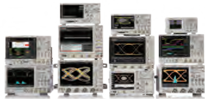
是德科技实时示波器横跨 20 MHz~63 GHz 带宽, 采样示波器达 90 GHz 带宽
