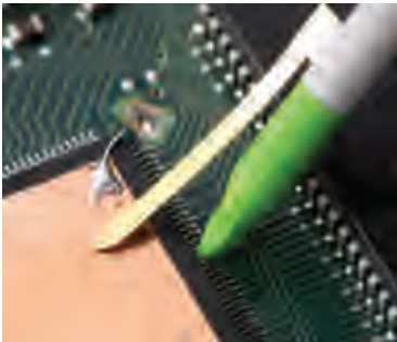
N287xA 系列无源探头 提供的低电感参数附件, 包括短的地线, 使得测量简便同时实现更高的系统带宽和信号完整性
