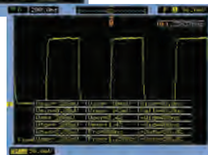
在屏幕上同时显示一个通道中的所有测量结果
