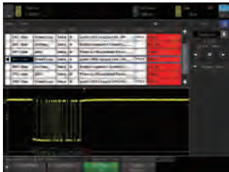
分段存储器与串行解码配合使用, 能够对串行总线进行最深入的分析
