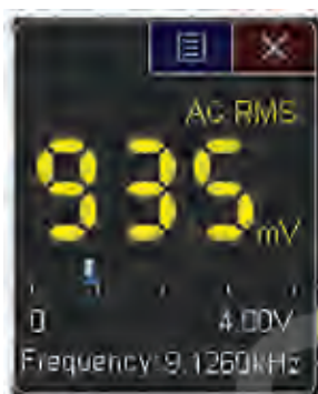
DVM 3位电压和5位频率测量弹指之间便可完成
