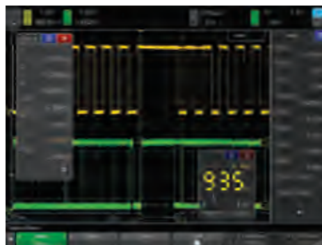
只需将指定的对接面板拖放到任何打开的区域内, 便可同时查看 10 种测量结果、光标信息和 DVM
