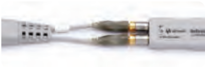
N2880A InfiniiMax 衰减器用在放大器和探头前端中间
