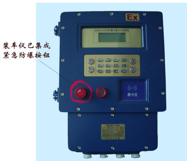
SP-ZC800 全自动定量装车仪，是珠海市摩尔自动化设备有限公司研制的新一代液态物料自动装车控制设备，可广泛应用于各种液态物料的定量装车控制，尤其适用于液态化工产品、石油制品的装车和装桶，是液态仓储行业的理想选择。
