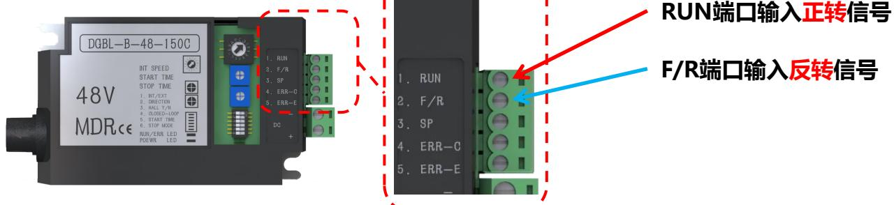
此模式下，RUN有效时，滚筒按默认方向转动；F/R有效时，滚筒按默认方向的相反方向转动；同时有效，滚筒不转
