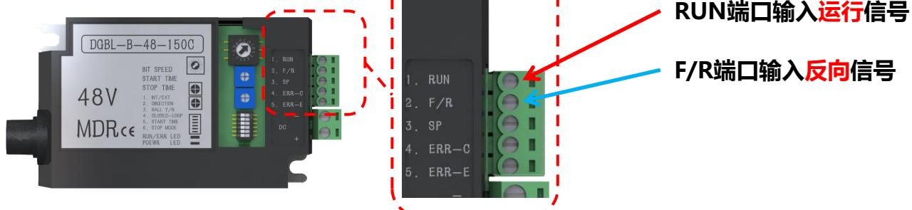
此模式下，RUN端口为运行使能端口；RUN有效时，滚筒按默认方向转动；RUN和F/R同时有效，滚筒按默认方向的相反方向转动
