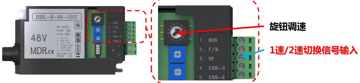
SP悬空，驱动卡工作在闭环1速模式；SP接高电平，驱动卡工作在闭环2速模式；速度范围可定制
