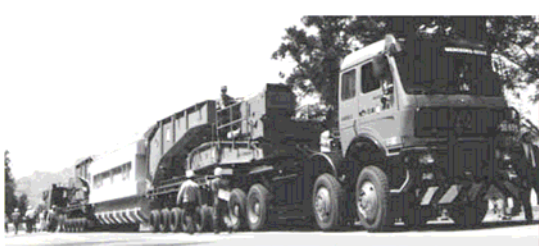
图 6 日本特高压变压器的运输 Fig. 6 UHV transformer transportation of Japan 2 特高压变压器的绝缘水平
