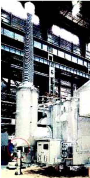
图 5 特高压变压器外部机械支撑 Fig. 5 External mechanical sustainer for UHV transformer 套管应能承受工频耐受电压 1 200 kV(5 min)和 1.5 U_m/\sqrt{3} ( U_m 为设备最高运行电压)工频电压下 1 h 的局部放电试验考核。值得注意的是,套管安装后,还要承受倍频下(不做频率/时间折算)的 1 100 kV (5min)和 1.5 U_m/\sqrt{3} 工频电压下 1h 的试验,制造厂应认真研究电压、频率和耐受时间对套管绝缘的影响。 1.4 运输
