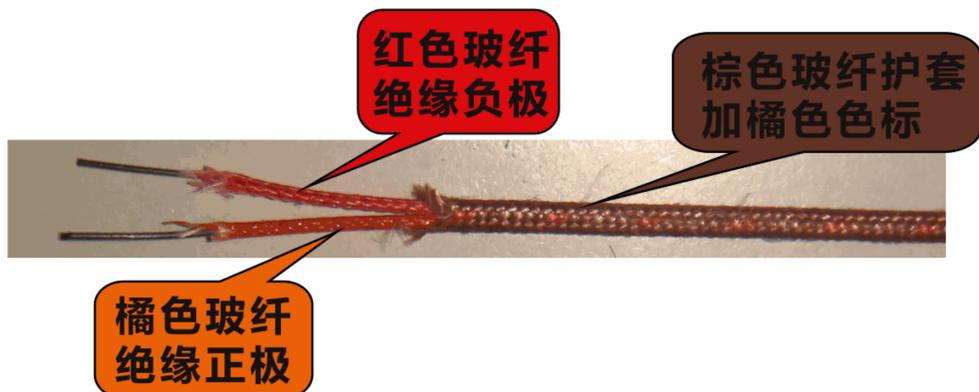
参照 ANSI 颜色码：正极线橘色，负极线红色。我们使用进口杜邦原料特富龙，3M 纤维绝缘，法国 ArcelorMittal 热电极，生产符合 OMEGA 标准的热电偶线
