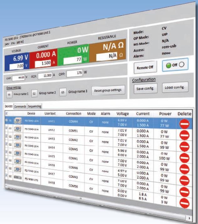
EA Power Control (EAPC) 是一款针对2014年新上市的产品系列用的新版Windows操作软件，这些产品都有ModBus通讯协议。它对电源与电子负载的支持方式一样，也可与USB与以太网数字接口配合操作。
