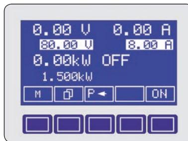
输出电压、电流和功率或可调内阻的调节，由两个旋钮完成。旋钮可在不同菜单设置下更改数值。为避免误操作，可锁定所有操作控制键。
