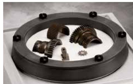
大型未镶嵌试样可轻易抛光。样品一旦装载便无需操作员过多留心。
