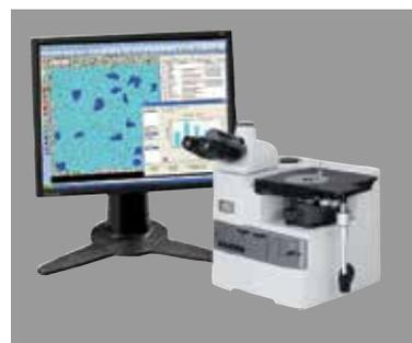
图像分析设备和硬度计包括：显微镜、镜头、图像分析软件、硬度计、夹具、硬度块和硬度测试软件。
