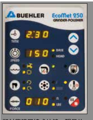
密封薄膜回馈式按键，醒目的LED指示灯易于读取操作指令。
