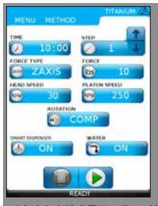
底盘和动力头文本模式界面，显示时间；加载力；速度；旋转方向；冷却水状态；滴液器状态；Z轴控制以及制备方法编辑/存储功能。
