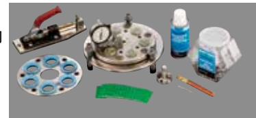
该附件主要用于印刷线路板上的镀铜通孔截面的样品制备。每次可以在卡具上的六个直径为1”（25mm）样品孔内放置样品，可同时制备多达36个样品。该附件可以精确控制材料去除速率，可制备直径为0.008”（200 μm）通孔纵向截面样品，需要中心力驱动适配器（60-9000需要单独订购）。
