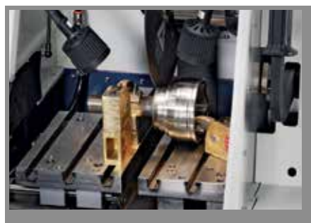
快速夹具和垫块配合使用, 在竖向提供加持力量, 可牢固装卡各种形状不规则的和尺寸较大的样品
