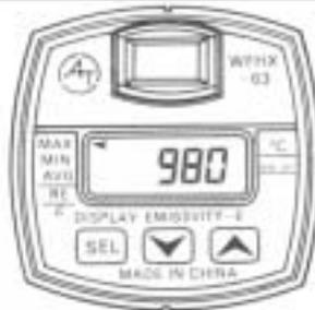
MIN: 显示采样时所有测量值中的最小值 (谷值)
