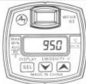
MAX: 显示采样时所有测量值中的最大值 (峰值).
