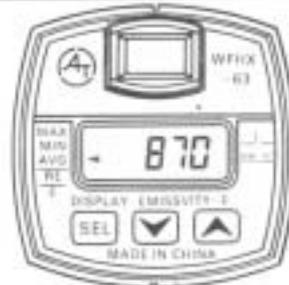
RE: 显示被测物体的辐射出射度 ( $\text{kW}/\text{m}^2$ )
