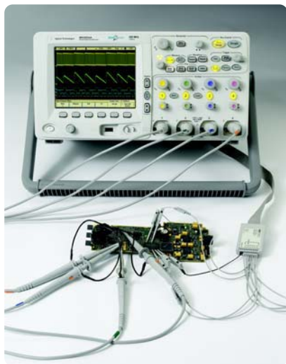
图 2. 4+16 通道 MSO 使您能用一台仪器观察 4 个模拟信号和 16 个数字信号。
