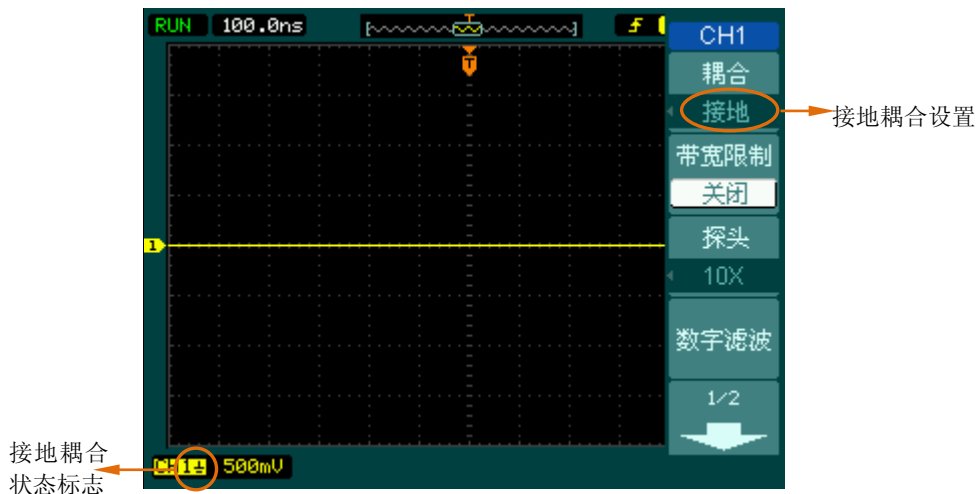
图 2-5 接地耦合设置
