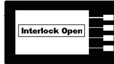
隨後又回到原先的畫面。因此必須先解除鎖定，才能進行測試，請安裝解除鎖定裝置，解除連結的鎖定。(若要解除此鎖定請將隨機附送的 **Interlock Disable Key** 插入背板顯示 SIGNAL INPUT 的端子上)
