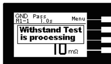
5. 在耐壓測試器與接地阻抗測試器同時執行測試時，ESD-140 的 LCD 顯示器會顯示如圖。
