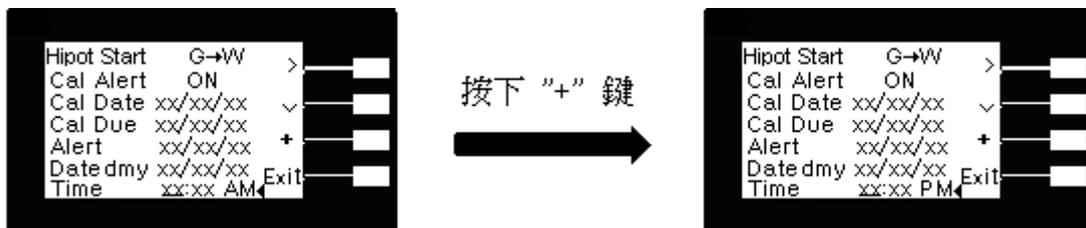
這是系統參數設定(System)的最後一個步驟，可以直接按“EXIT”鍵離開測試參數設定模式，而進入待測模式，準備正式進行耐壓測試。
