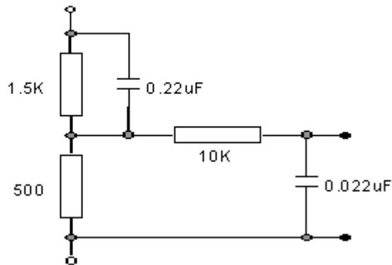
人體阻抗模擬電路所代表的英文字會顯示在畫面上測試棒選擇右邊，ESC-125 人體阻抗模擬電路是以英文字母 A、E、F 和 G 作為代表。ESC-112 人體阻抗模擬電路是以英文字母 A、B、C、D、E、F 和 G 作為代表。假設所選擇人體阻抗模擬電路為 A 時，畫面顯示如下：
