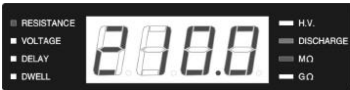
被測物(DUT)阻值超過設定值(210.0MΩ)顯示
