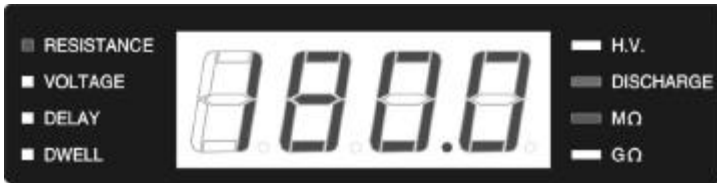
此畫面測試通過阻值(180 MΩ)顯示
