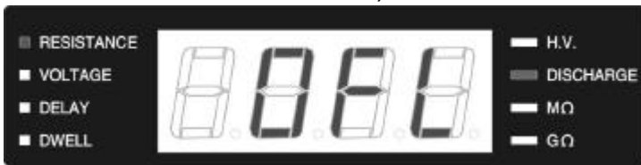
被測物(DUT)阻值不在量測範圍( > 200.0GW for 8210, >50GW for 8205 )顯示
