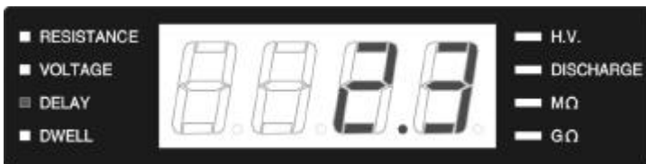
測試中斷(2.3sec)的顯示
