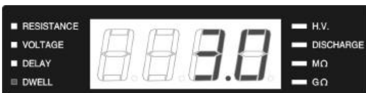
測試中斷(3sec)的顯示
