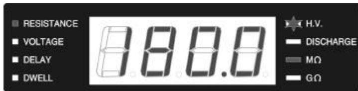
測試進行時量測到被測物阻值(180MΩ)顯示
