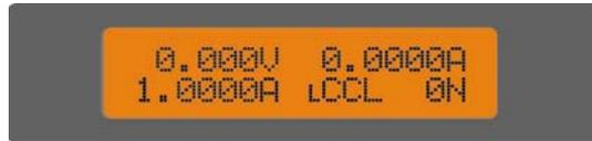
液晶屏上排显示实际电压和电流，下排显示 List 中的设定值、序列测试 (lCCH 为大电流模式序列测试，lCCL 为小电流模式序列测试，lCV 为定电压模式序列测试，lCRL 为小电阻序列测试，lCRM 为中电阻序列测试，lCRH 为大电阻序列测试。小写字母 L 表示序列测试) 及负载输入状态(ON 为打开，OFF 为关闭)。
