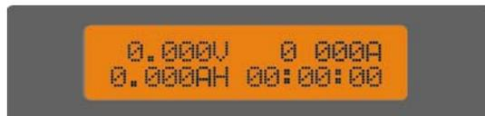
液晶屏上排显示实际电压和电流，下排显示电池容量及放电时间。
