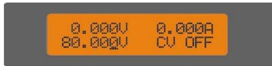
液晶屏上排显示实际电压和电流，下排显示设定电压值、定电压模式及负载输入状态(ON 为打开，OFF 为关闭)。
