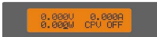
液晶屏上排显示实际电压和电流，下排显示设定功率值、定功率模式（CPC 为定功率电流源模式，CPV 为定功率电压源模式）及负载输入状态(ON 为打开，OFF 为关闭)。
