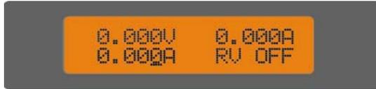
保护状态包括过电流 (OC)、过电压(OV)、过功率(OP)、过温度(OT)、负载保护(PT)、极性反接(RV)。
