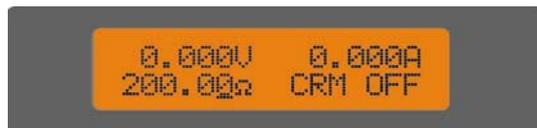
液晶屏上排显示实际电压和电流，下排显示设定电阻值、定电阻模式（CRL 为小电阻模式，CRM 为中电阻模式，CRH 为大电阻模式）及负载输入状态(ON 为打开，OFF 为关闭)。
