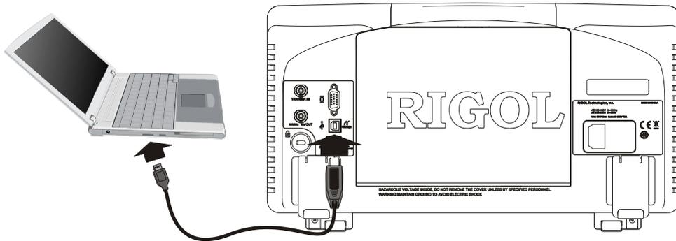
频谱仪与 PC 正确连接后，接通仪器电源，此时 PC 上将弹出“硬件更新向导”对话框，请按照向导的提示安装“USB Test and Measurement Device”。
