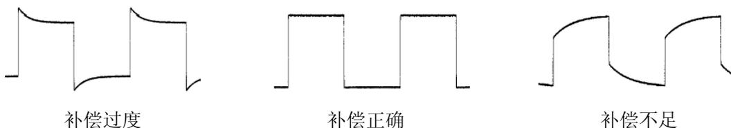
图 1-11 探头补偿显示波形示意图
