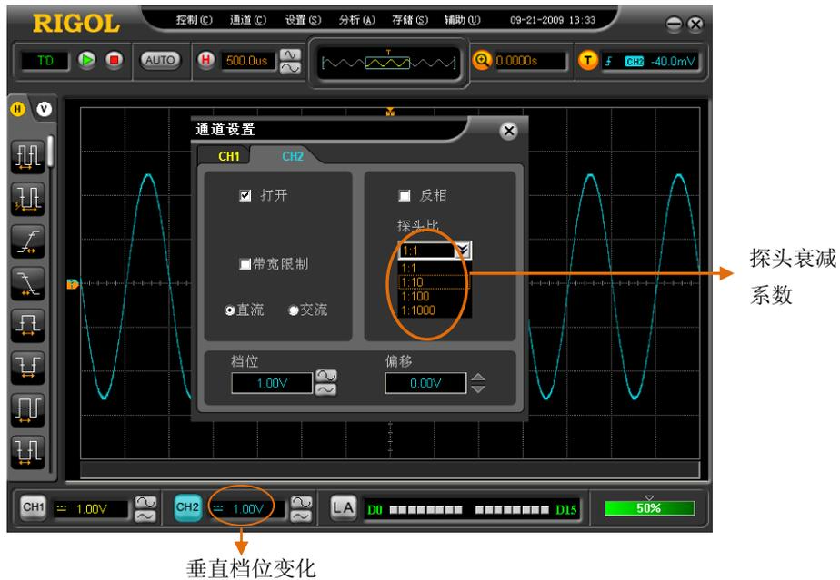
图 2-6 探头衰减比例设置
