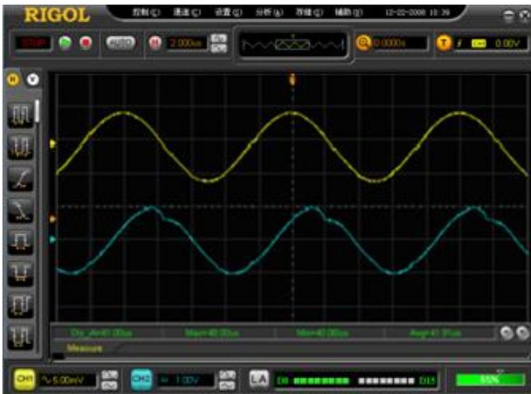
图 3-1 波形畸变示意图
