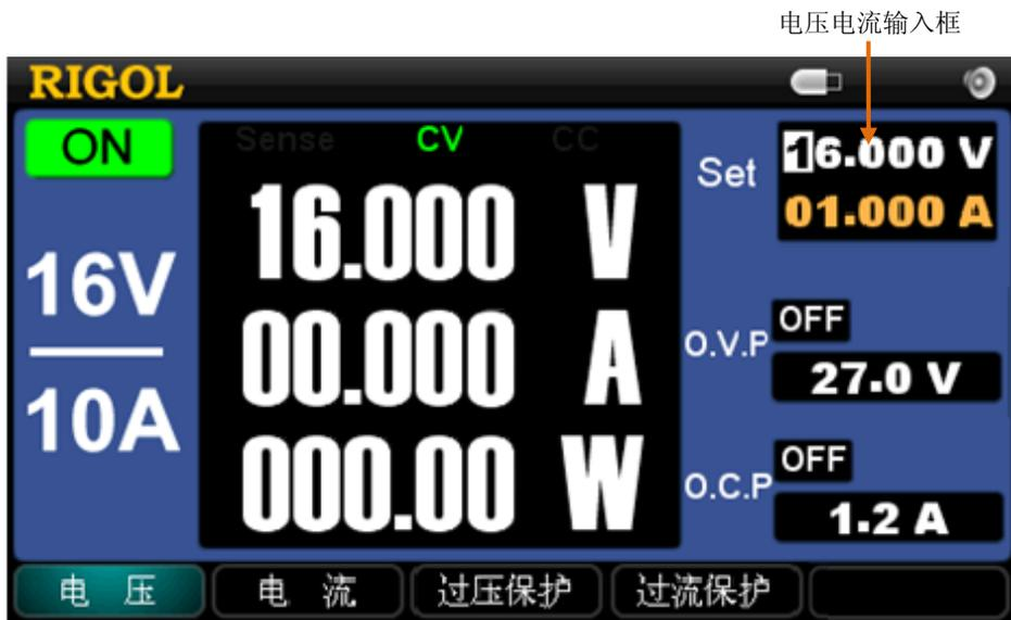
图 2-3 直接参数输入
