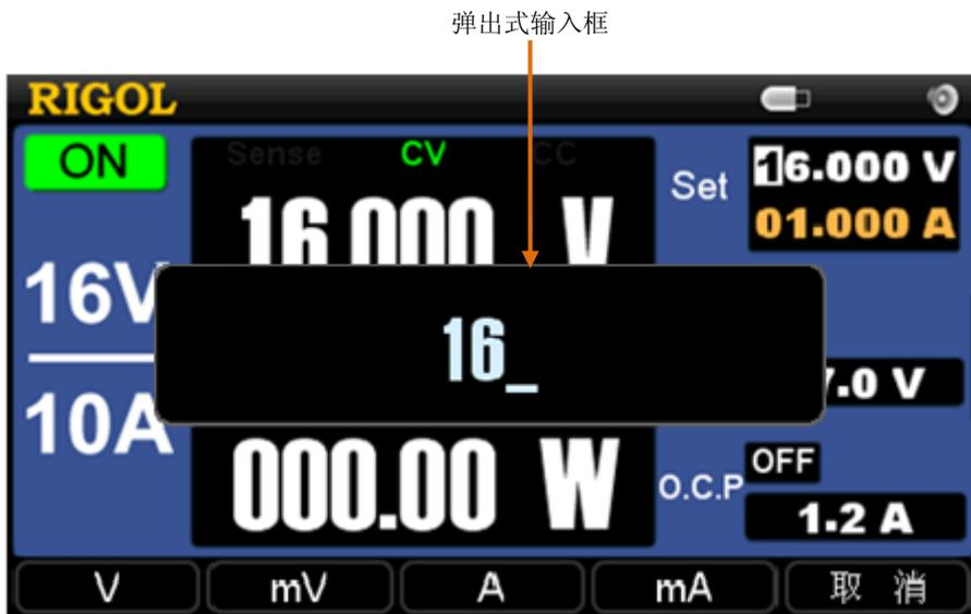
图 2-2 弹出式参数输入
