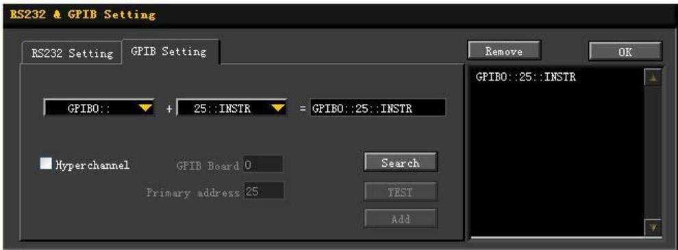
图 3-14 GPIB 通信设置
