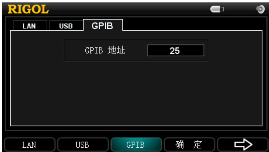
图 2-21 GPIB 地址设置
