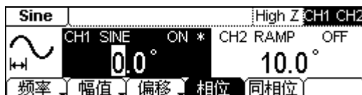
图 3-20 通道耦合显示界面
