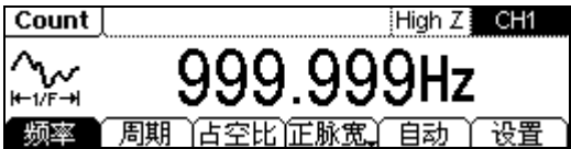
图 2-62 频率计设置界面
