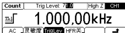
图 2-63 设置耦合方式
