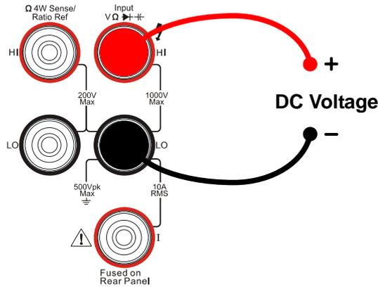
图 1—8 直流电压的测量示意图
