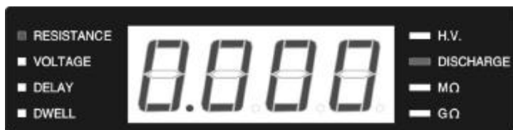
被測物(DUT)阻值不在量測範圍( < 0.001MΩ)顯示
