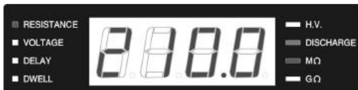
被測物(DUT)阻值超過設定值(210.0MΩ)顯示
