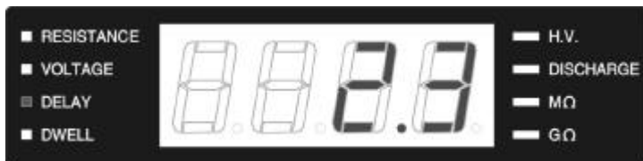
測試中斷(2.3sec)的顯示
