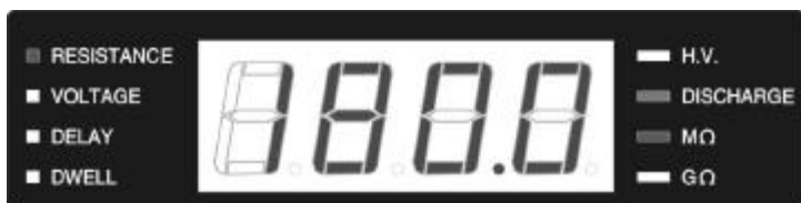
測試中止時量測到被測物阻值(180MΩ)顯示
