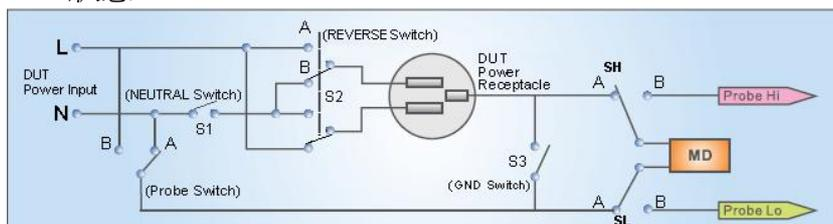
被測物狀態：單一故障、L/N 反向（對 L 線 Single Fault to Line）
