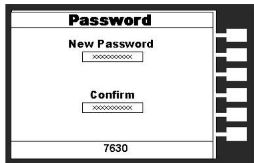
使用者可利用數字鍵去建立一 10 個位數的新密碼，再按”ENTER”鍵去接受新密碼或按”EXIT”鍵去跳離建立密碼功能。在使用者輸入新密碼被系統接受後，必須在”Confirm Password”處再次輸入您所設定的新密碼，然後按”ENTER”鍵去確認該密碼已被設定完成，亦可按”EXIT”鍵去跳離建立密碼功能(此時密碼並未被建立完成)。
