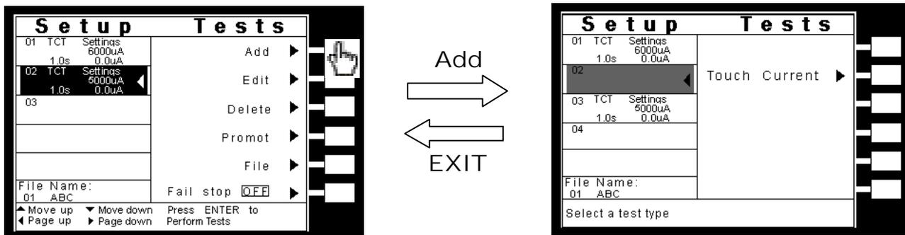
若有選購 OPT. 752 Run Module 功能，則會有“接觸電流測試 (Touch Current)”及“產品電氣性能測試 (Run Test)”兩個測試選擇項目，如下圖。
