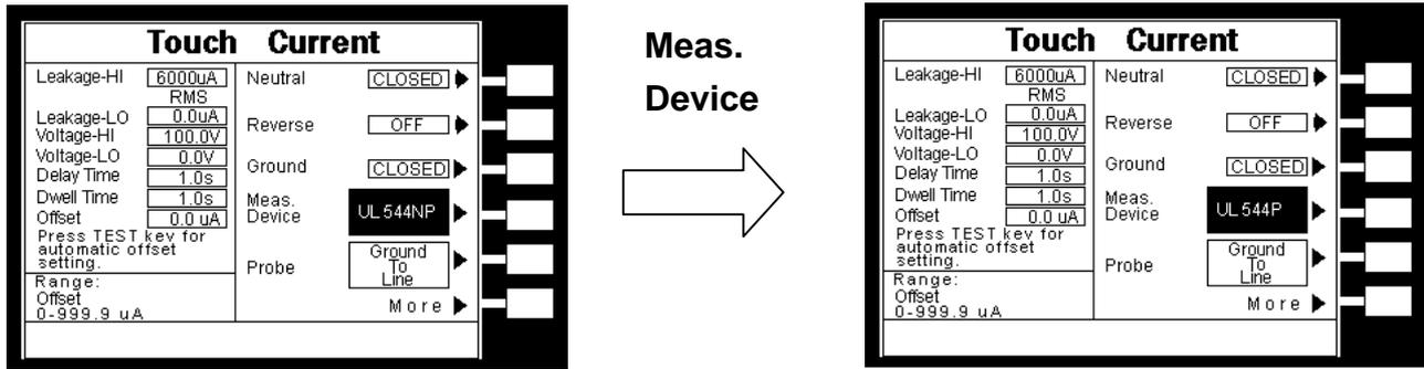
人體阻抗模型為模擬人體阻抗的電路，是由安規執行單位指定作為洩漏電流量測的依據，下列為人體阻抗模型(MD)所使用的英文字代號和安規規範的對照表及其說明：
