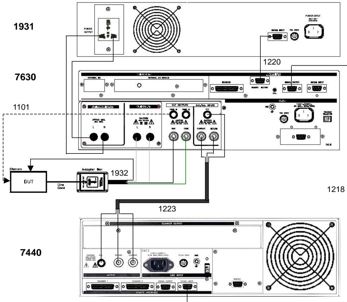
圖二 7630 + Opt.752 RUN Function + Opt.753 HV & GB Link Module 與 7440、待測物、待測物工作電源 (1931) 接續圖
