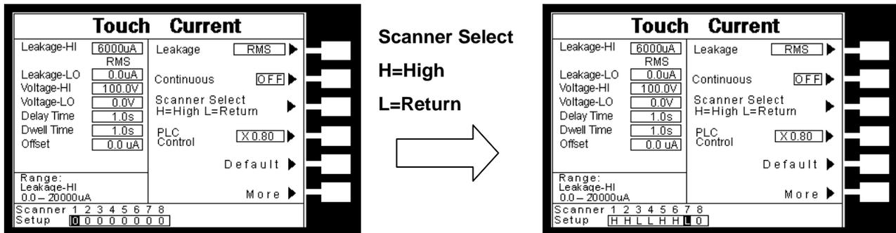
如果測試通道 (Channel) 超過 8 個點，則必須外接掃描器，當設定 Channel1~8 之狀態後，外接掃描器的指示燈就會顯示每個通道的設定狀態。
