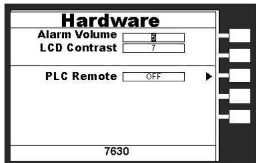
若選購有 GPIB 功能，在此界面卡連接上 7630 時，系統會自動偵測，在硬體功能設定模式會增加 GPIB 地址設定(GPIB Address)功能項。
