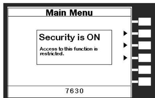
隨後又回到原先的畫面。因此必須先解除鎖定，才能進行測試參數的設定。請參照鍵盤鎖定的說明，解除鍵盤的鎖定。
