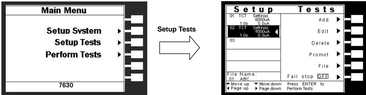
7630 有 50 個測試程式記憶組(File)，每組具有 30 個測試步驟(STEP)，每個測試步驟均可依序連結到下一個測試程式記憶組的測試步驟。但每個測試步驟只能設定一種測試功能。
