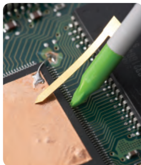
N287xA 探头的低电感接地连接保持探头低负载，以实现信号完整性测量。
