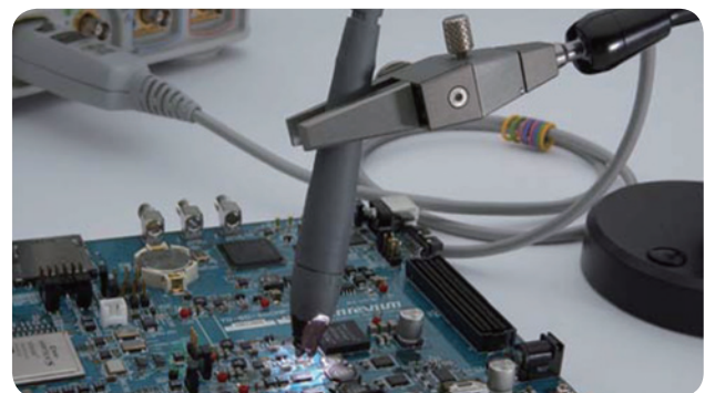
图33: 只需一个探针，并且无需更改或重新连接，N2750A InfiniiMode探头可灵活支持差分、单端和共模信号测量。
