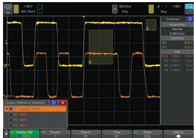
图32: 存储和调用多达4个参考波形。
