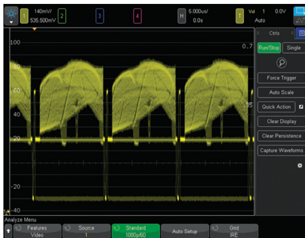
图26: 在 1080p HDTV 信号分析上进行触发。
