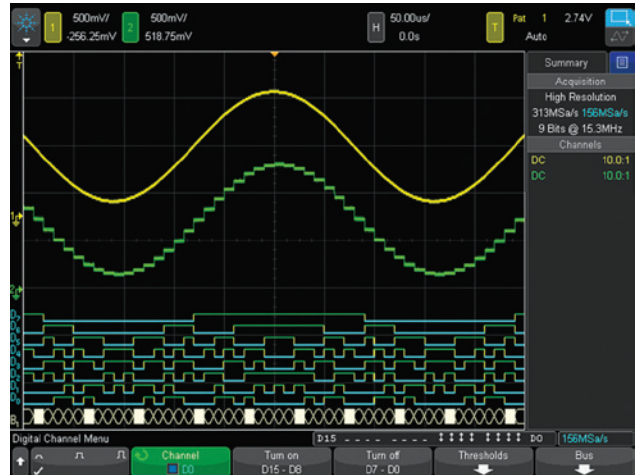
图 18: 数字通道的捕获和显示与 MSO 或升级后的 DSO 中的模拟通道有时间关联。
