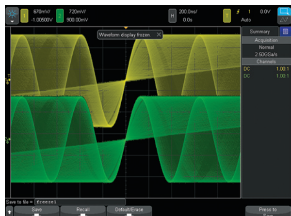
图 42: “冻结显示”特性可在停止波形采集的同时在屏幕上保留亮度级信息。
