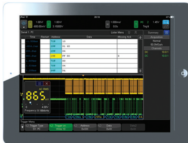
图 36: 平板电脑虚拟前面板控制控制界面。
