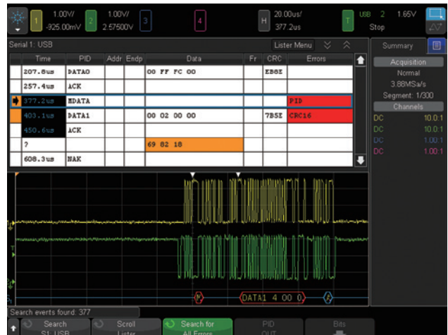
图 20: USB 2.0 触发、解码和“列表”显示。
