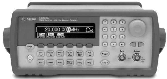
调整频率、幅度、偏置和其它参数。甚至能直接用 V<sub>pp</sub>, V<sub>rms</sub>, dBm 或高低电平送入电压值。定时参数能以赫兹 (Hz) 或秒送入。
