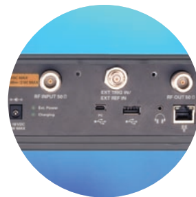
N9340B 支持 USB 和 LAN* 上通过 SCPI 的远地控制
