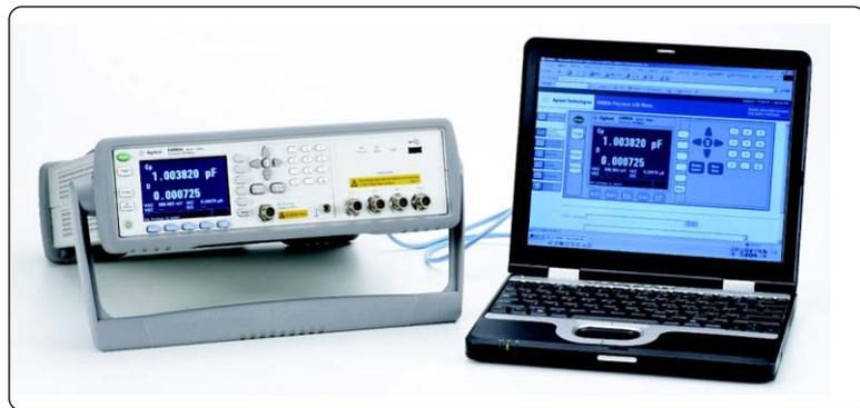
图 12. 用计算机和网络浏览器在 LAN 上方便地控制 E4980A LCR
