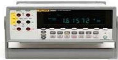
Fluke8808A 前面板上的六个按钮的功能就像汽车收音机上的电台预设按钮一样。只需为某一常用测量设置仪表，按 Shift 按钮，然后再按其中一个设置按钮（S1 至 S6），即可保存设置。以后每次执行该测量时，只需按一下相应的设置键即可。就这么简单！设置按钮省去了操作员遵守复杂的操作说明书的麻烦。操作员不必再依次按下多个按钮来设置测量功能和量程、测量极限值或输入其它测量参数。
