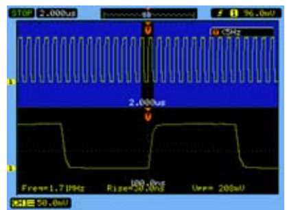
图 6. 使用真实缩放 (True Zoom) 模式, 您可以同时观察波形的全貌以及波形的细节, 您可以在查看一段较长时间记录的同时在缩放窗口中观察信号的细节。
