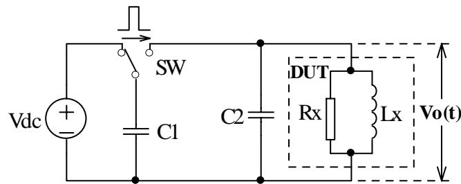
图 1-1 线圈脉冲测试原理简图
