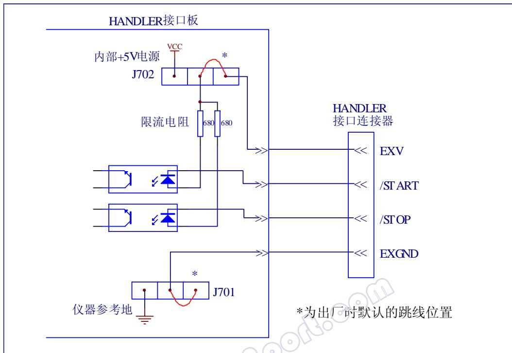
图 7-2 输入信号简化示意图
