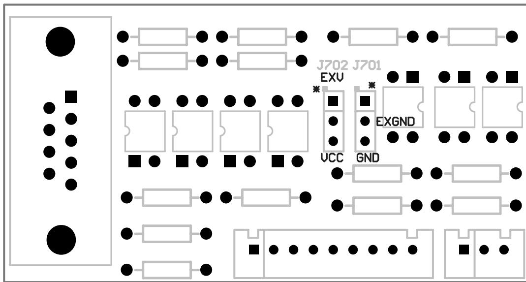
图 7-3 跳线在 HANDLER 板上的位置
